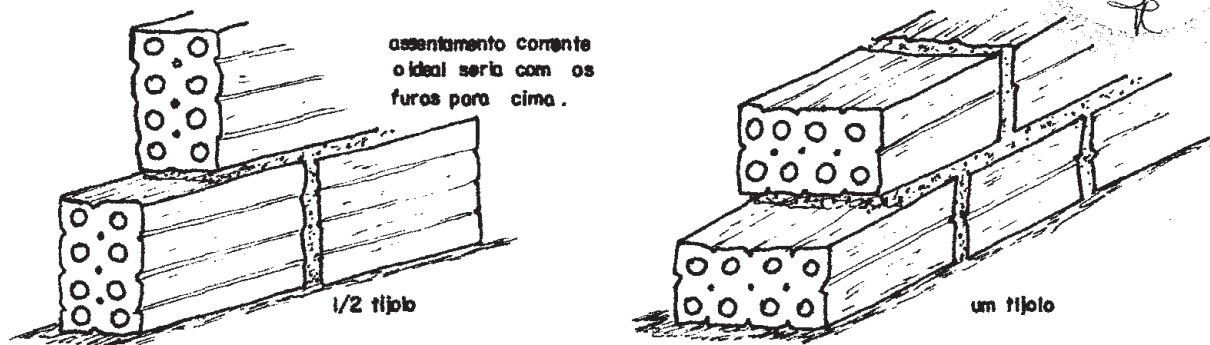
Figura 1 - Execução de alvenaria utilizando tijolos furados.
