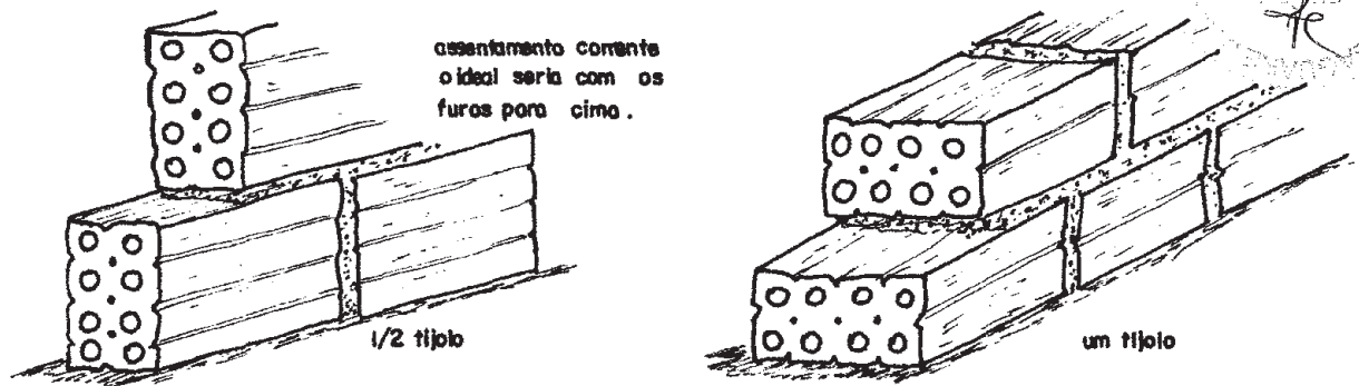
Figura 1 - Execução de alvenaria utilizando tijolos furados.
